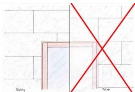
Colocación de las placas en huecos
